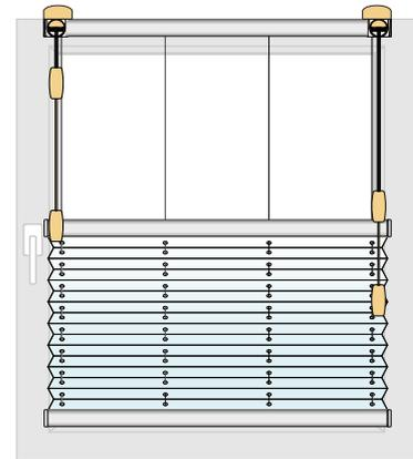
Die Plissee Klemmträger mit eloxierten Haltern sind nur für Fenster mit Gummidichtung geeignet. Die Plissee-Klemmträger sind in unterschiedlichen Farben passend zur Auswahl der Profilfarbe erhältlich. Bei der Montage werden diese einfach mit beiliegendem Inbusschlüssel am Fensterflügel montiert. Beim Aufmaß ist darauf zu achten, dass die Plisseeanlage nicht mit Fensterbeschlägen wie dem Fenstergriff kollidiert. Ein seitlicher Überstand von je 1,5 cm pro Seite ist zu empfehlen.
