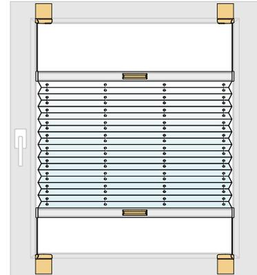
Die auf dem Fensterrahmen geklebte Montagetechnik Stick und Fix front ist hervorragend für etwas größere, verspannte Plissees, jedoch nur für Kunststofffenster geeignet. Die aus weißem Kunststoff bestehenden Klebträger werden bei der Plisseemontage auf den Rahmen geklebt. Nach einigen Stunden kann der Plissee Faltschirm einfach eingehängt werden. Beim Aufmaß ist die Tiefe der Glasleisten zu beachten.
